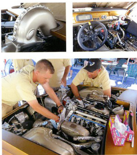
そのジョージが所有、かのRad Rides by Troyが走らせるプリマス・バラクーダ“Blowfish”もやってきたが、最初のランでシリンダーヘッドに穴をあけ必死の作業で修復。結果的に249.945mphを叩き出した。モーターはMoparのスプリントレース用V8モーターをターボ化したもので、レースカーにも関わらず細部の作り込みや美しさはトロイならでは。
