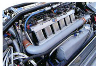
ベテランビルダー、Automotive Machine Serviceによりハイパフォーマンス化されたストレート8気筒の320cu.inモーターで臨むヘアメタルの'52年型ビュイック・スーパー・リビエラ。ボディはチョップ、ストレッチ、ウエッジされたレース専用のもの。2009年に133mphを記録していたが、今回は8番シリンダーを破損しレースを終えた。
