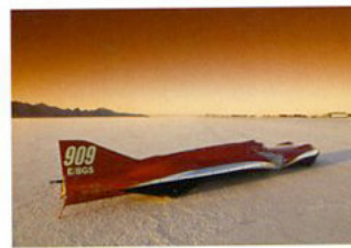
Speed Nymph=スピードの妖精と名付けられたストリームライナーはカリフォルニア州San JoseのベテランレーサーDennis Varniが新たに仕上げて初挑戦するもの。バックスピークやデザートレース向けのGM製ストレート6モーターをツインターボ化したもので、317.739mphをマークした。二基のタービンによる排気音の吸収が効いているのか、このレーサーは音がほとんど聞こえなかったのが印象的であった。
