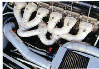
Speed Nymph=スピードの妖精と名付けられたストリームライナーはカリフォルニア州San JoseのベテランレーサーDennis Varniが新たに仕上げて初挑戦するもの。バックスピークやデザートレース向けのGM製ストレート6モーターをツインターボ化したもので、317.739mphをマークした。二基のタービンによる排気音の吸収が効いているのか、このレーサーは音がほとんど聞こえなかったのが印象的であった。
