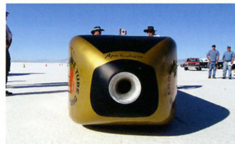
ネヴァダ州で毎年開催されている“バーニングマン・フェスティバル”にオブジェを製作している有名なアーティストDavid Best氏が、長年の夢を叶え初めてレースに参加。そのマシンがこのホンダZ600だ。ストックのモーターにターボを装着して50馬力を発揮し、ストックのトランスミッションと組み合わせて85.060mphを記録。'70年代前半に世界中に販売されたこの小さな空冷二気筒エンジンの大衆車が、見事に世界記録を樹立したのである。
