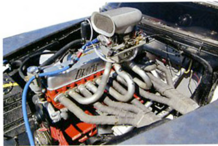
ベテランビルダー、Automotive Machine Serviceによりハイパフォーマンス化されたストレート8気筒の320cu.inモーターで臨むヘアメタルの'52年型ビュイック・スーパー・リビエラ。ボディはチョップ、ストレッチ、ウエッジされたレース専用のもの。2009年に133mphを記録していたが、今回は8番シリンダーを破損しレースを終えた。
