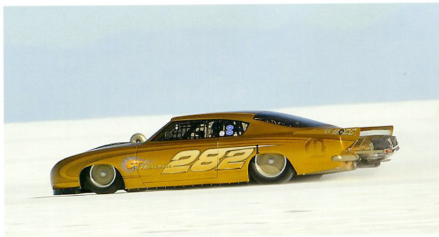
そのジョージが所有、かのRad Rides by Troyが走らせるプリマス・バラクーダ“Blowfish”もやってきたが、最初のランでシリンダーヘッドに穴をあけ必死の作業で修復。結果的に249.945mphを叩き出した。モーターはMoparのスプリントレース用V8モーターをターボ化したもので、レースカーにも関わらず細部の作り込みや美しさはトロイならでは。
