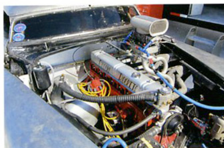
ベテランビルダー、Automotive Machine Serviceによりハイパフォーマンス化されたストレート8気筒の320cu.inモーターで臨むヘアメタルの'52年型ビュイック・スーパー・リビエラ。ボディはチョップ、ストレッチ、ウエッジされたレース専用のもの。2009年に133mphを記録していたが、今回は8番シリンダーを破損しレースを終えた。
