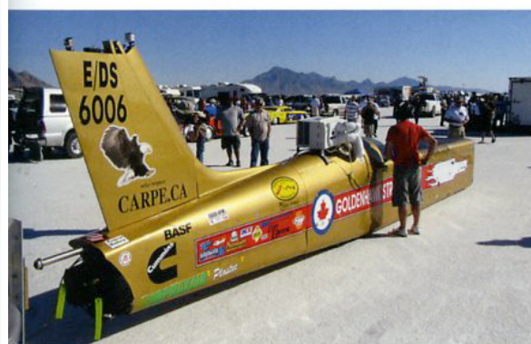
カナダからやってきたこのストリームライナー“Goldenhawk”は、4気筒のディーゼルエンジンを搭載。ドライバーを冷やすため、待機している間はボディにエアコンを載せるという気合いがいりだったが、レースの過酷さに耐えられず記録をマークすることはできなかった。
