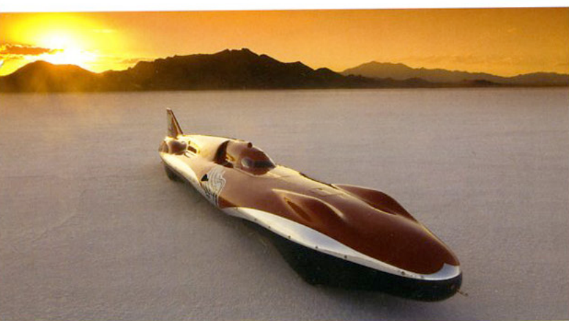
ベテランビルダー、Automotive Machine Serviceによりハイパフォーマンス化されたストレート8気筒の320cu.inモーターで臨むヘアメタルの'52年型ビュイック・スーパー・リビエラ。ボディはチョップ、ストレッチ、ウエッジされたレース専用のもの。2009年に133mphを記録していたが、今回は8番シリンダーを破損しレースを終えた。
