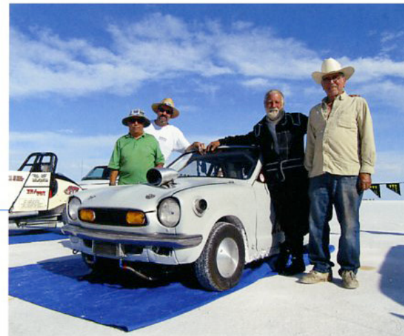
ネヴァダ州で毎年開催されている“バーニングマン・フェスティバル”にオブジェを製作している有名なアーティストDavid Best氏が、長年の夢を叶え初めてレースに参加。そのマシンがこのホンダZ600だ。ストックのモーターにターボを装着して50馬力を発揮し、ストックのトランスミッションと組み合わせて85.060mphを記録。'70年代前半に世界中に販売されたこの小さな空冷二気筒エンジンの大衆車が、見事に世界記録を樹立したのである。
